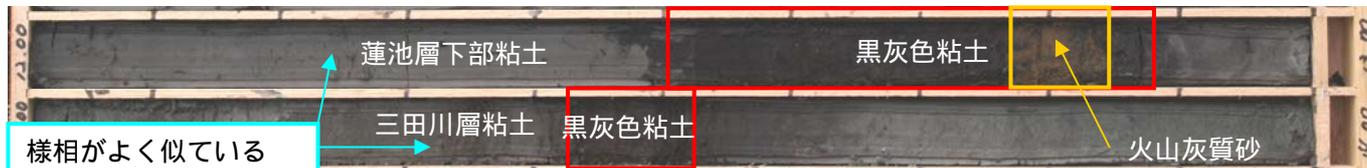
図-2 沖積層と洪積層の境界付近のボーリング試料写真
