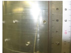
写真-2 ケーシングの通気孔径2mm概観
