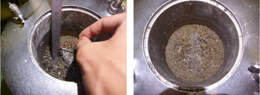
(1) ケース(a)A - 浸透深さ 2.7cm (2) ケース(a)C - 浸透深さ 0cm 写真 4.1 試験後トランジション材表面の状況
