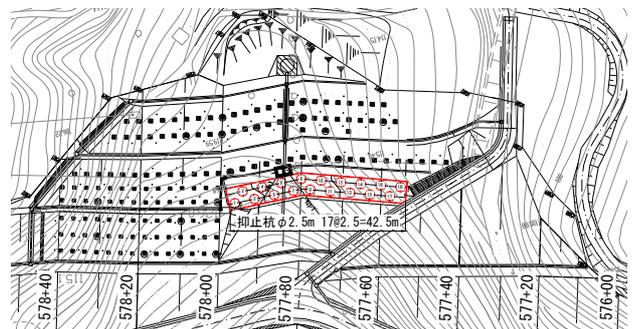
図-3 地すべり抑止杭の配置平面
