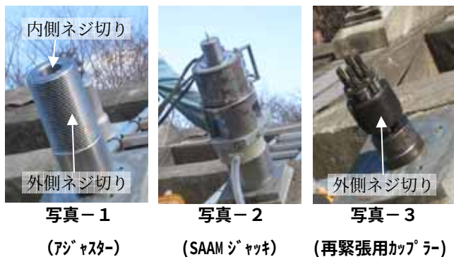
図-3 緊張力測定と既設アンカーへの荷重計の設置
