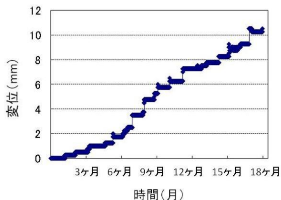
図-2 表層崩壊の変位(伸縮計)
