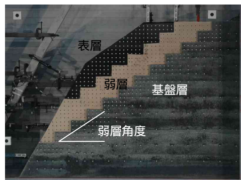
図1 岩盤斜面模型
