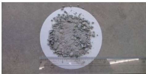
写真-1 徐冷フェロニッケルスラグ -5mm
