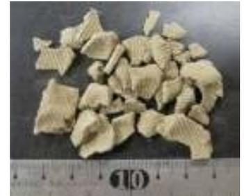
写真1 加圧脱水浄水汚泥
