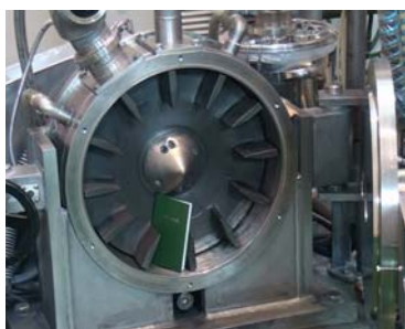
図-1 高速気流中衝撃法の装置 4)
