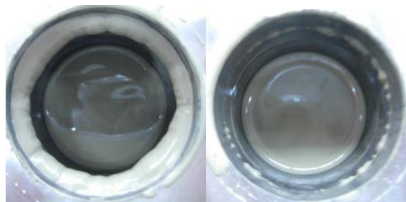
図-10 試験終了後のスリット入口のフィルターケーキ (注入圧力 0.1MPa、左: SF、右: 表面改質 SF)
