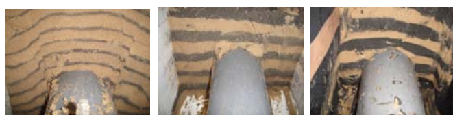
(a)未対策 (b)固化改良体対策 (c)防砂シート対策 写真1 実験後の断面図
