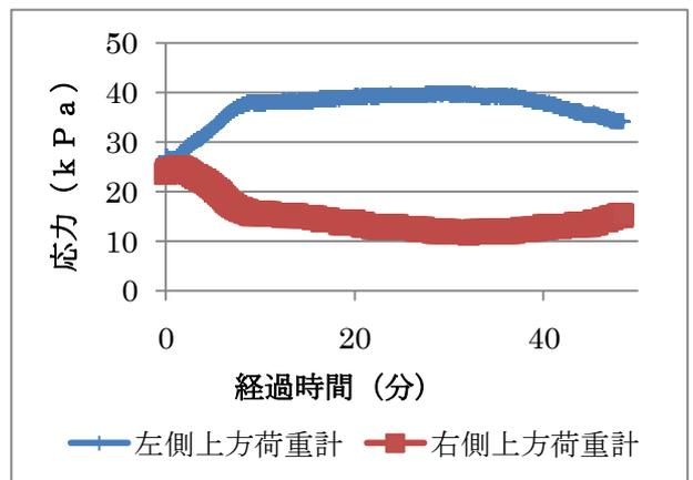
図-4 せん断中の反力側左右応力
