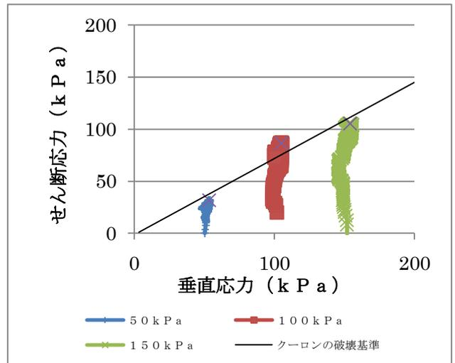
図-2 破壊線
