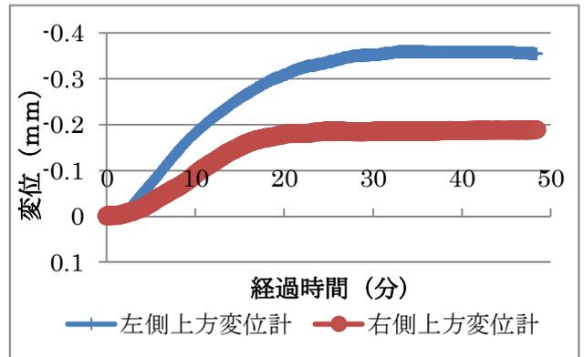
図-3 せん断時の反力側左右変位
