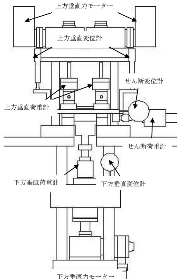
図-1 高知高専型一面せん断試験機
