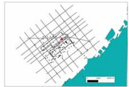
図-2 ボーリング地点と音波探査位置図 (黒点：ボーリング，黒実線：探査測線 赤三角は KIX18-1)
