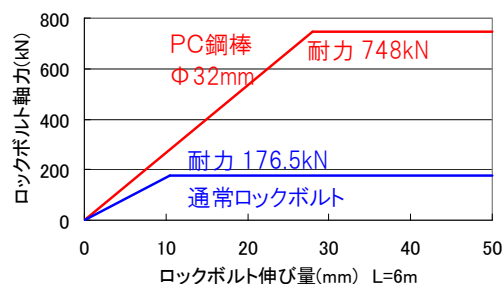
図3 ロックボルト変位量と軸力の関係
