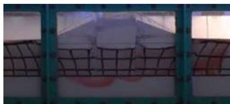
写真 1(2) L2 加振後の堤体の状況(Case3)
