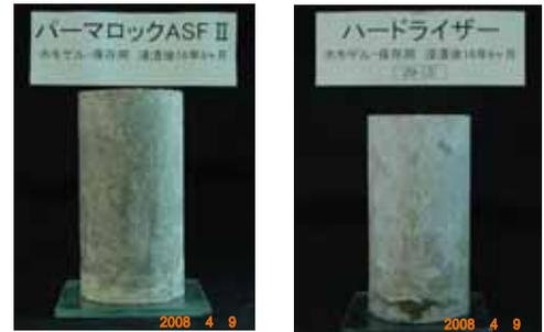
写真-1 ホモゲル中で16年半養生後のモルタル供試体の状況とマスキングシリカの形成<sup>1,2)</sup>
