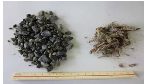
写真-3 切削した岩ズリと木片
