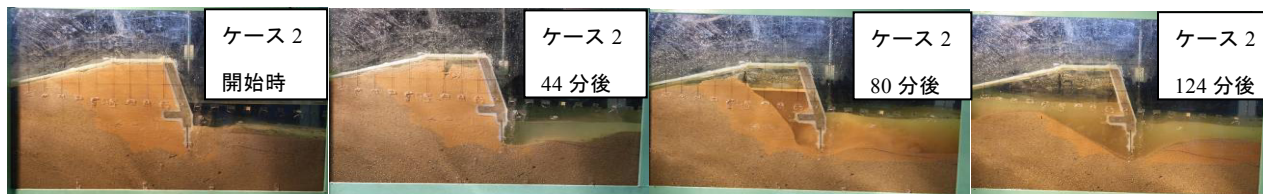
図-2 ケース 2 の堤防前面洗掘と堤体内からの吸出しの状況
