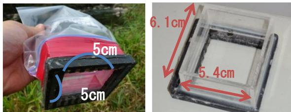
図-2 巨礫の付着藻類の計測器
