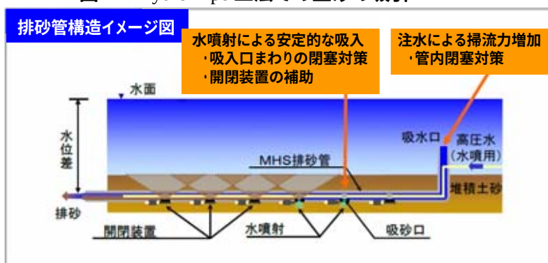
図-2 MHS 工法での土砂の吸引 2)
