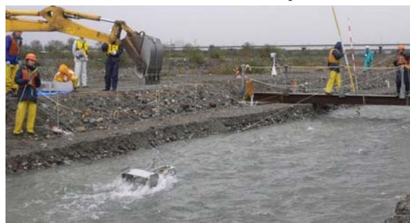
写真-2 改良 H-S sampler による流砂観測状況
