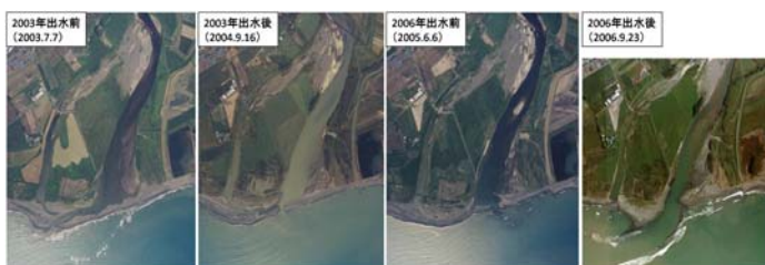
写真-1 鵠川河口域の出水による変遷(室蘭開発建設部より)
