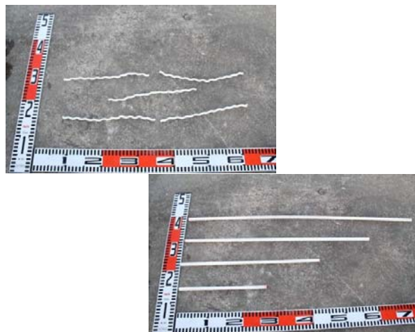
写真-3.2 実験で再現した流木の例
