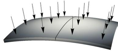
図-2 数値解析例：亀裂が中央に入ったシェルの4辺を固定し，等分布荷重を加える．
