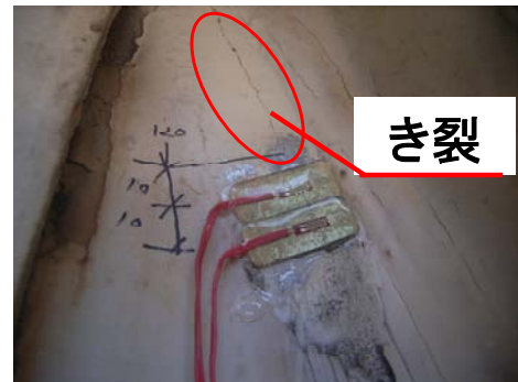
図.3 ひずみゲージ貼付状況(き裂先端)
