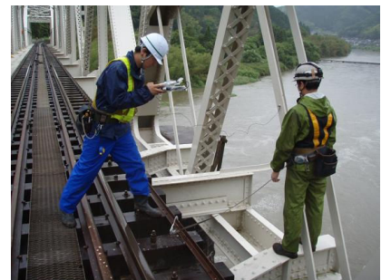
写真2 アイバー振動数測定
