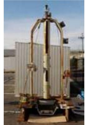
図1. 落下式衝撃試験機
