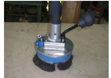
写真-1 橋梁洗浄用スチームヘッド
