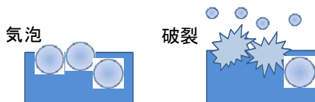
図1 海面からの飛来塩分の発生のメカニズム
