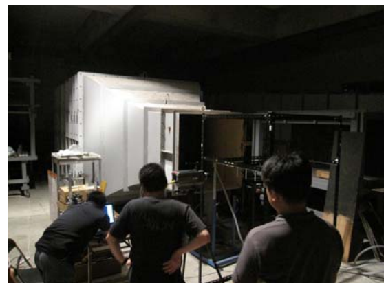
写真2 風洞試験機 (最大風速20m/s)
