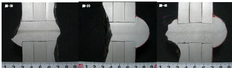
図.7 母材が腐食したリベット接合
