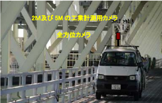
図 4 10km/h で走行しながらの撮影状況
