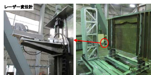
写真4 レーザー変位計およびウェブ初期変形計測状況
