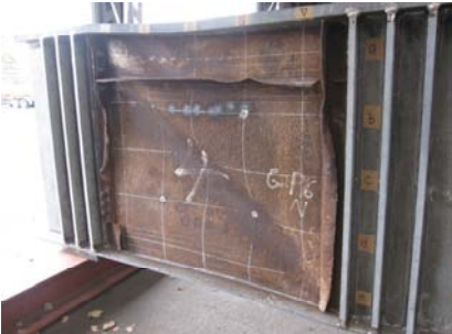
写真 5 耐荷力試験終了時のウェブ面外座屈モード
