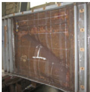
図2 せん断座屈変形モードの一例 (Type C)
