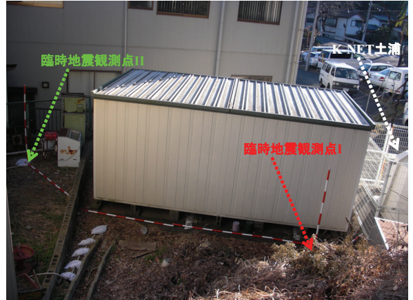
写真-1 K-NET 土浦近傍での臨時地震観測状況
