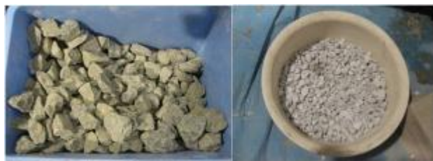
図3 建設材料の混合砕石と砂利
