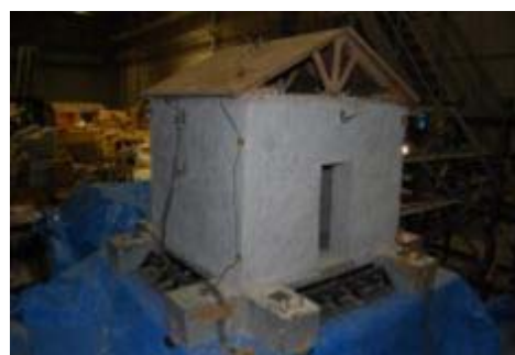
図2 振動台実験を行なった石積み組積造住宅 （PPバンド補強した住宅）
