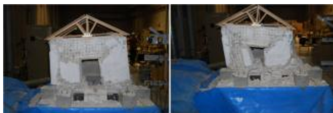
図 5 Run52 (左)・Run53 (右) 後の 石積み組積造補強モデル
