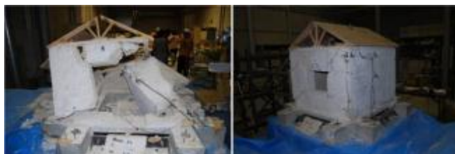
図 4 Run48 後の石積み組積造モデル (左：無補強モデル 右：補強モデル)
