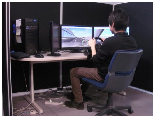
図1 走行実験に使用する簡易ドライビングシミュレータ
