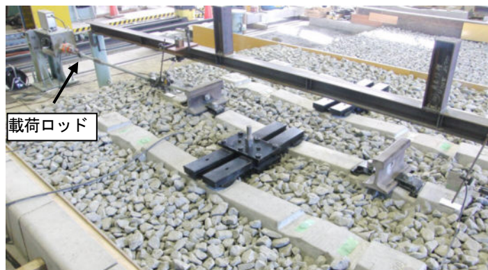
図 5 横抵抗力試験の状況
