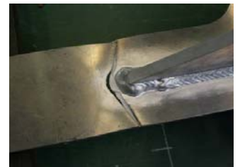
写真-1 破断写真 (素材：A5083P-0)
