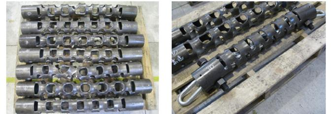
写真-3 試験体(載荷後)
