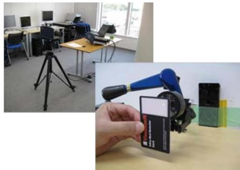
図1 不可視レーザー光を用いたLDV
