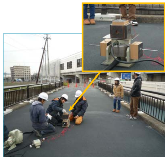
写真-1 小型起振機による C 橋の起振実験
