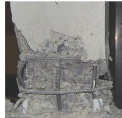
写真-2 最終破壊(三角形荷重)
