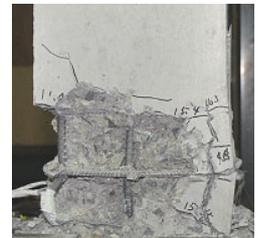
写真-3 最終破壊(斜め荷重)
