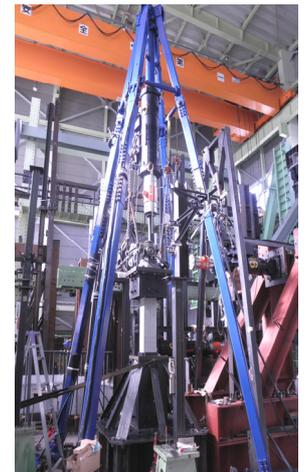
写真-1 二軸載荷装置 (愛知工業大学)
