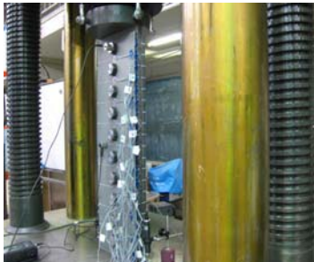
写真-1 圧縮試験の全景
