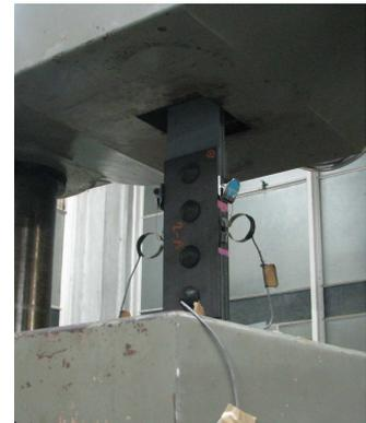
写真1 引張試験の状況
