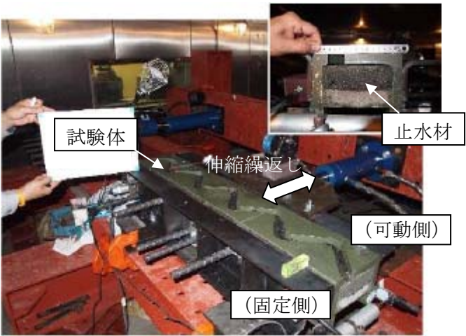
図7 伸縮繰返し試験状況
