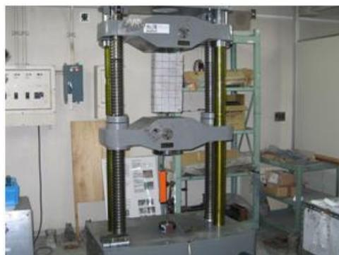
写真-1 万能試験機による両引き試験状況
