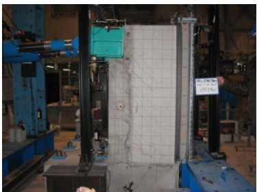
写真-2 背面土有りのケース(左：最大荷重時、右：載荷終了後のパラペット部)
