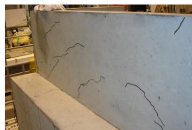
写真-1 背面土無しのケース(左：最大荷重時、右：載荷終了後のパラペット部) 1)
