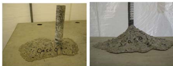
写真-4.1 接着材の違いによる破壊形態の違い
