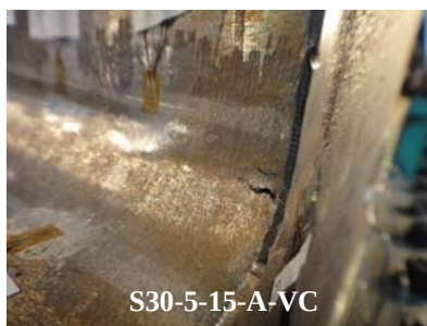
写真-4 き裂発生状況（載荷途中）
